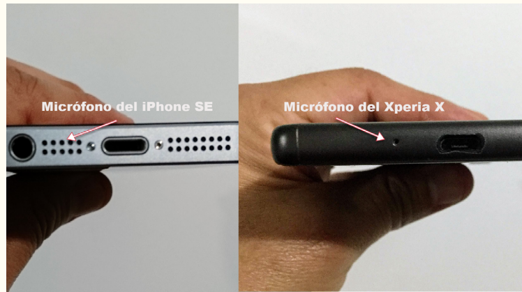
Imagen 14. Micrófono integrado instalado de fábrica del iPhone SE y el Xperia X situados en la parte inferior de ambos dispositivos.
